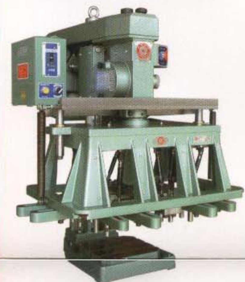
齒輪式牙距自動攻牙機 (電腦銑金外殼多軸攻牙)
